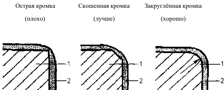
Рис. 2.1. Обработка острых кромок. 1 - Металл; 2- Покрытие
